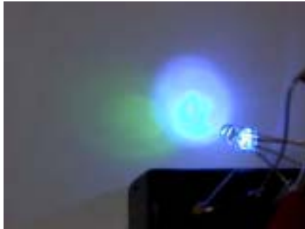
写真1 青と緑の光軸がずれている
