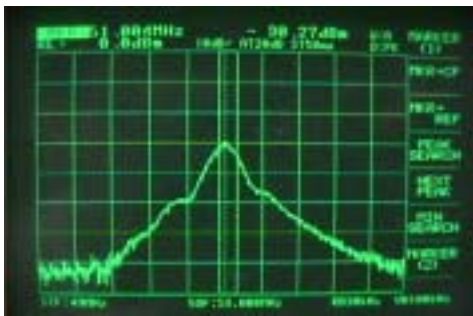
写真4 アンテナ端子から放射されるクエンチングノイズ
