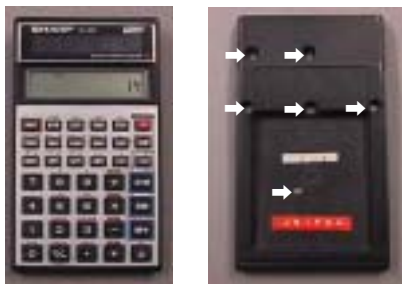
写真1 計算機 の表と裏矢印のねじをはずす
