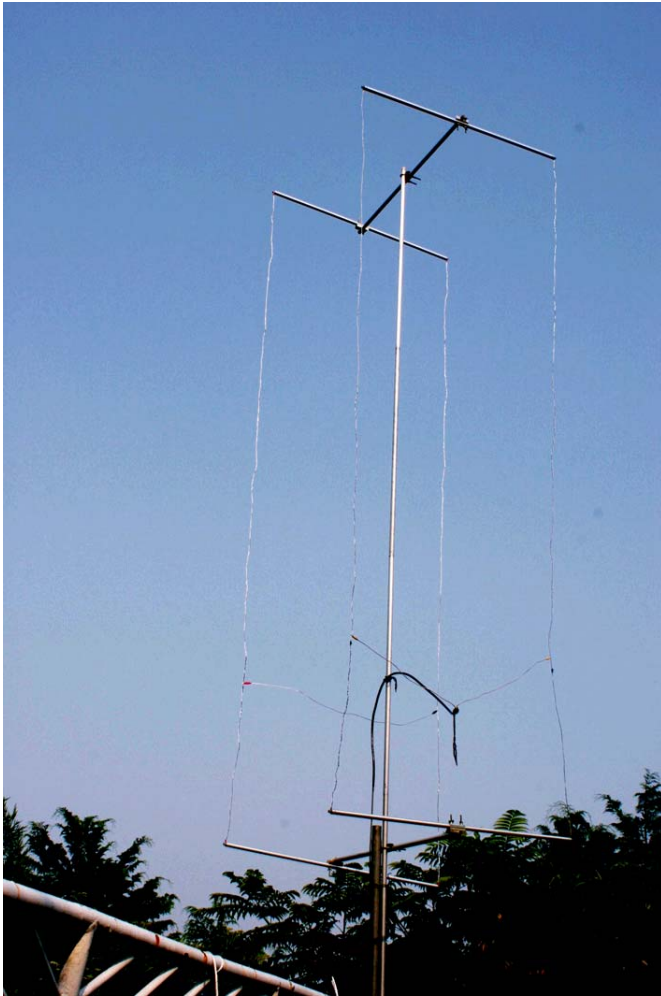
写真2 2エレメントヘンテナの全体写真
