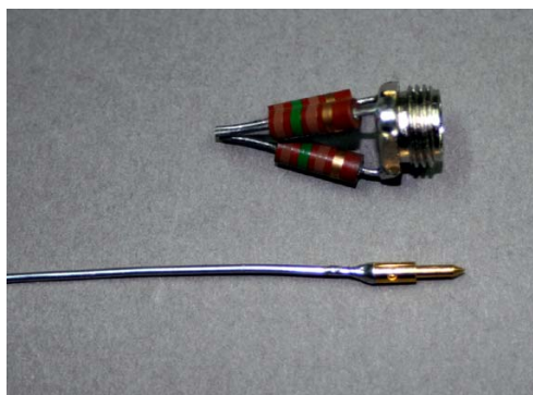
<写真2> 芯線の先と抵抗の取り付け
