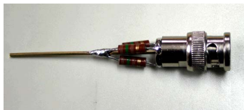
<写真3> 芯線に抵抗をセットする
