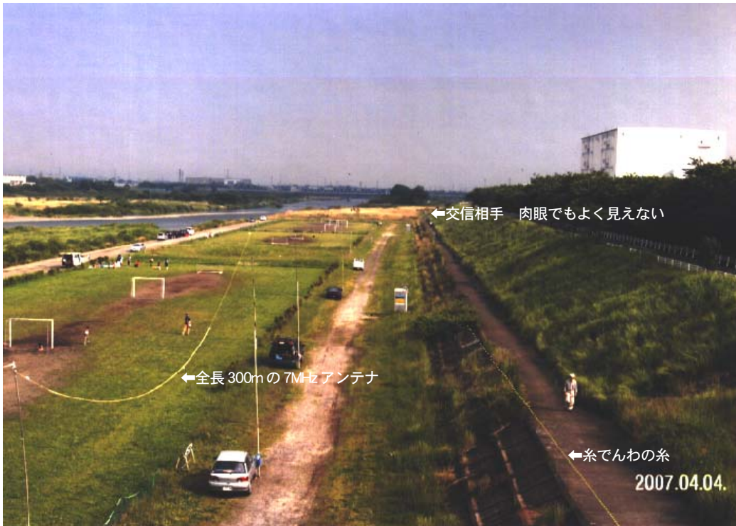
<写真1> 実験場風景、右側が糸でんわ、左側がアンテナの実験 写真の日付は間違いです。
