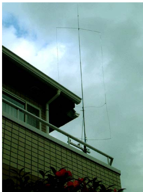
ベランダに設置した超軽量ヘンテナ
