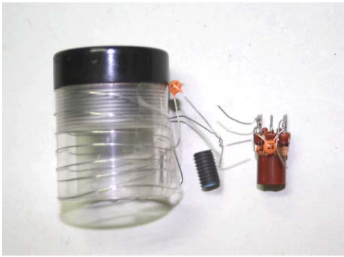
写真1 試験した共振回路 左19MHz、右45MHz
