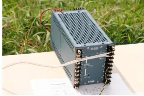
写真2 スwitching電源改造送信機
