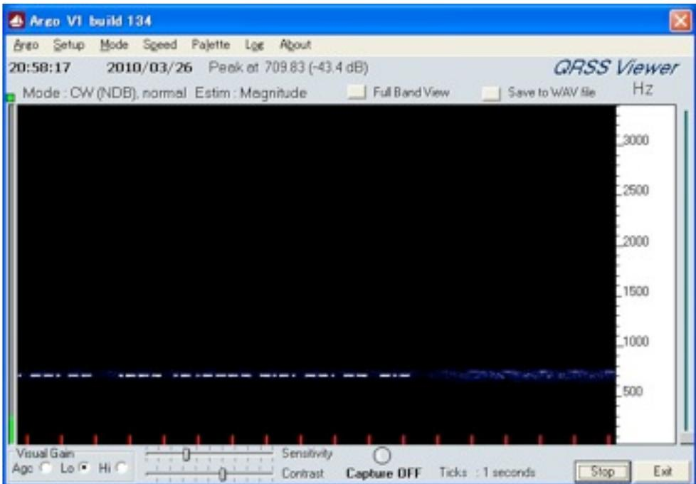
第3図 PA0RDT-Mini-Whipによる受信状況 符号と符号の間に青いノイズが見える。右側の青いノイズは送信が終わった後のバックグラウンドノイズです。
