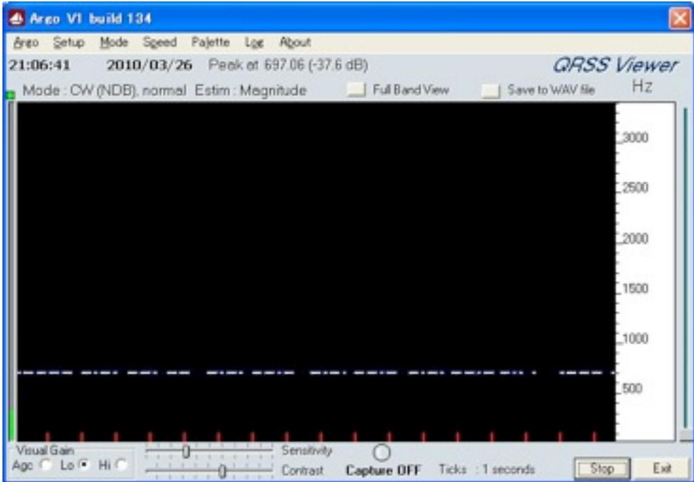
第2図 地面アンテナの受信状況 図の下の700Hzの所に受信したモールス符号がはっきりと読める
