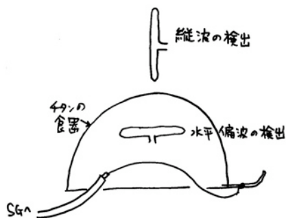
第2図 縦波検出実験
