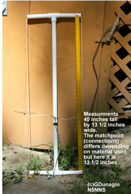
4エレメントヘンテナを作るための試作品
