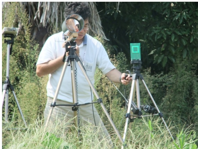
1.4kmの交信に成功した緑色LEDを使った送信機(右端)と受信機(中央)
