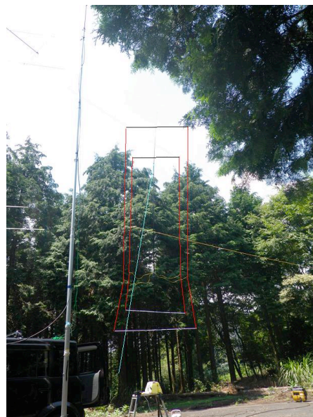
2010年FDで使用したヘンテナの様子 山頂を示す柱にロープで釣竿を固定。(写真の写りが悪いのでアルミ線を赤色に着色しています。)
