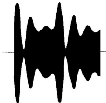
第6図 電波のAMの波形
